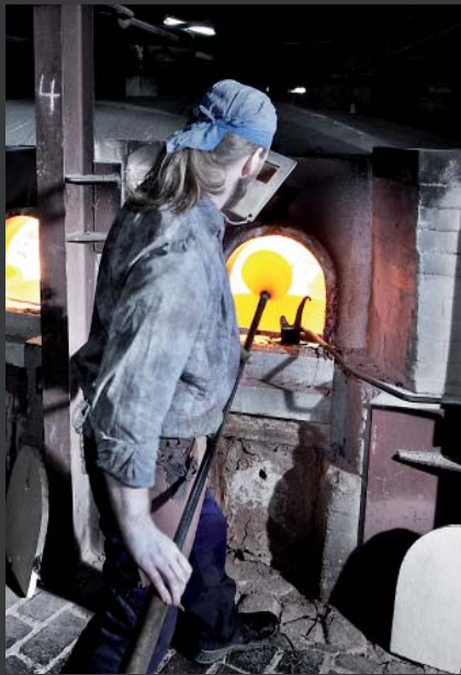
Aufnahme der zähflüssigen Glasmasse an die Glasmacherpfeife.
