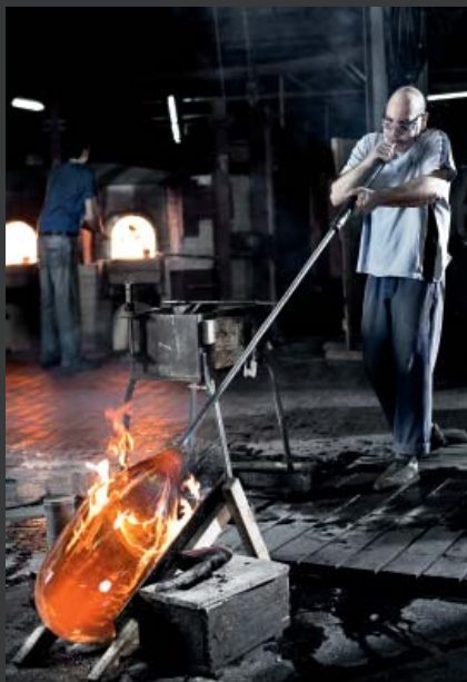
Durch gleichzeitiges Drehen und Blasen des Glasballons entsteht die für mundgeblasene Gläser typische Bewegung in der Glasoberfläche.
